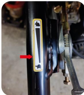
**ATENÇÃO:** Caso exceda esse valor (25%), há o risco de ao ligar o motor este tenha capacidade o suficiente de fazer com que a máquina funcione sem que o operador esteja preparado para iniciar as operações, fato que pode resultar em acidentes ou danos à máquina.
